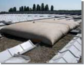
SERBATOIO PIANO PER PROVA CON CARICO DISTRIBUITO
