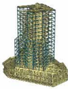
Struttura in c.a. e acciaio
