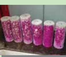
CARBONATAZIONE SU PROVINI IN CLS
