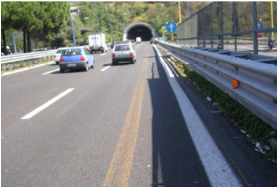
Fig. 55 - Coesistenza di segnaletica temporanea e permanente (carreggiata est, km 16 + 200)
